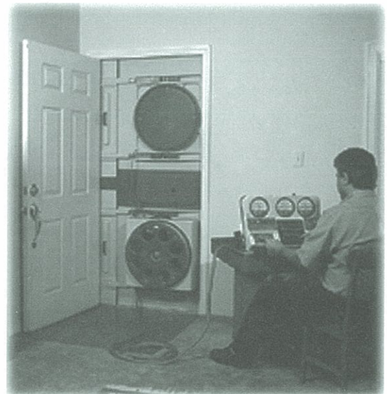
Infiltrometer Blower Door Test Instrument
